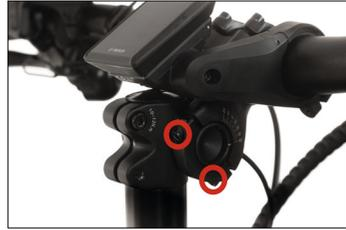
In einem zweiten Schritt muss der Lenker in Gegenrichtung verdreht werden
