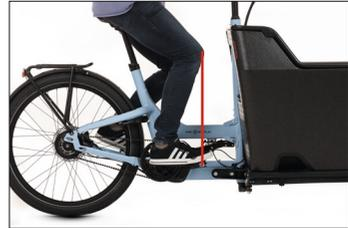
Setzen Sie sich in der oben aufgezeigten Position mit waagerechten Kurbelarmen auf das CD2 und lassen Sie eine zweite Person das Knielot ermitteln.
