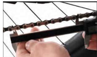
Ab 120,5 mm ist die Kette soweit verschlissen, dass diese Kettenblatt (Stahl) und Ritzel (Stahl) übermäßig abnutzt. Tauschen Sie in diesem Fall die Kette gegen eine neue Kette aus.
