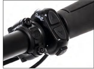
Wenn das Pedelec aus einer Geschwindigkeit von mehr als 10 km/h zum Stillstand gebracht wird, kann das System automatisch auf einen eingestellten „Anfangsgang“ zurückschalten.
