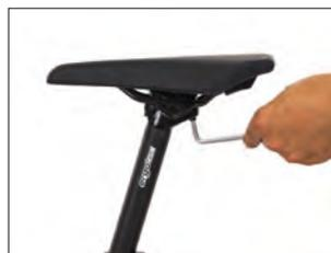
Stellen Sie die Neigung des Sattels horizontal oder mit der Sattelspitze leicht nach unten geneigt ein. Ziehen Sie anschließend die Schrauben mit 10-12 Nm fest.
