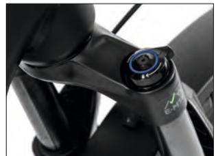
Geschwindigkeit Ausfedern = Zugstufe
