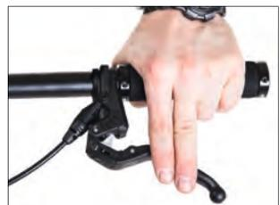
Durch Lösen der Schraube an der Lenkerschelle kann der Bremsgriff auf dem Lenker verschoben werden. Wenn Sie die richtige Position gefunden haben, ziehen Sie die Griffe zunächst nur so weit fest, dass sie noch verdrehbar sind. Stellen Sie im nächsten Schritt den Winkel der Bremsgriffe ein.
