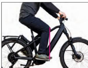
Setzen Sie sich in der oben aufgezeigten Position mit waagerechten Kurbelarmen auf das Fahrzeug und lassen Sie eine zweite Person das Knielot ermitteln.
